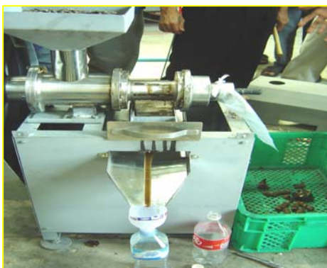
ภาพผนวกที่ 4 การหีบน้ำมันสุญ์ดำด้วยเครื่อง Screw Press
