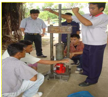
ภาพผนวกที่ 3 การหีบน้ำมันสบู่ดำด้วยเครื่อง Hydraulic Press
