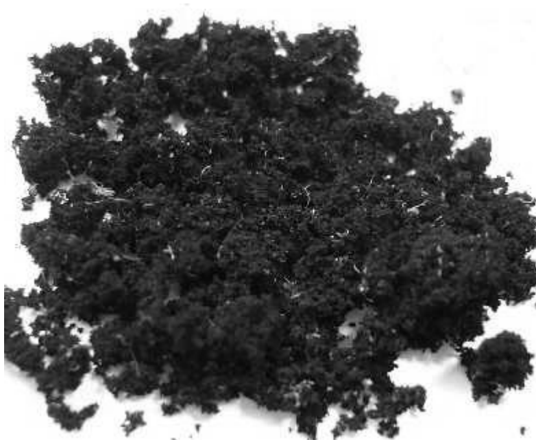
ภาพที่ 18 พงยางที่ผลิตจากหินเจียรละเอียดความเร็วรอบ 2,900 rpm (พงยางละเอียด)
