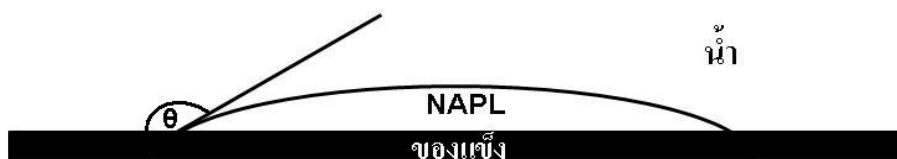
ภาพที่ 10 มุมสัมผัสของ NAPL บนพื้นผิวของแข็งที่เป็น strongly oil-wet ล้อมรอบด้วยน้ำ
