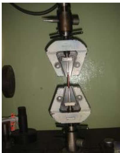
ภาพที่ 3.18 การจับยึดชิ้นงานกับเครื่องทดสอบแรงดึง
