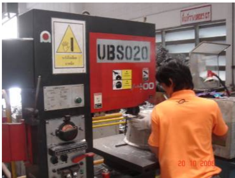
ภาพที่ 3.13 การตัดชิ้นงานเพื่อเตรียมไว้สำหรับการกลึง
