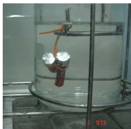
ภาพที่ 3.22 การชั่งน้ำหนักขึ้นงานในน้ำ
