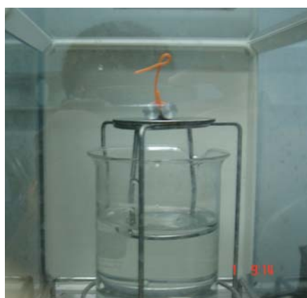
ภาพที่ 3.21 การชั่งน้ำหนักขึ้นงานในอากาศ
