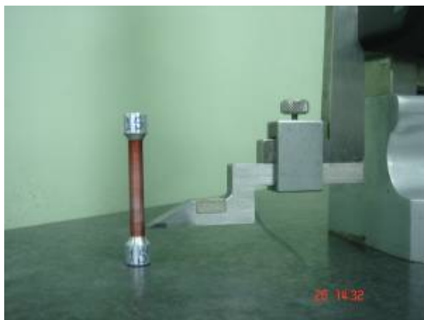
ภาพที่ 3.17 วิธีการขีดgauge length
