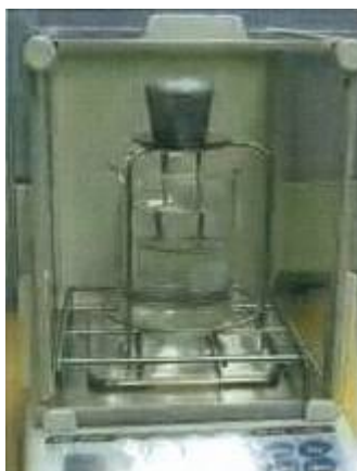
ภาพที่ 3.6 การชั่งน้ำหนักชิ้นงานในอากาศ
