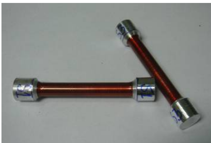
ภาพที่ 3.16 ชิ้นงานสำหรับทดสอบแรงดึง
