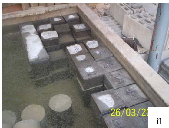
ภาพที่ 12 ก. แท่งตัวอย่างลูกบาศก์ที่บ่มในน้ำ และ ข. แท่งตัวอย่างคานที่นำไปบ่มน้ำ
