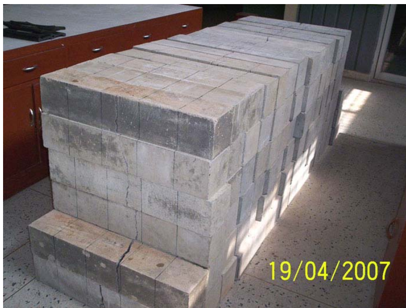
ภาพที่ 16 แท่งตัวอย่างคานคอนกรีตที่ทดสอบเสร็จแล้ว
