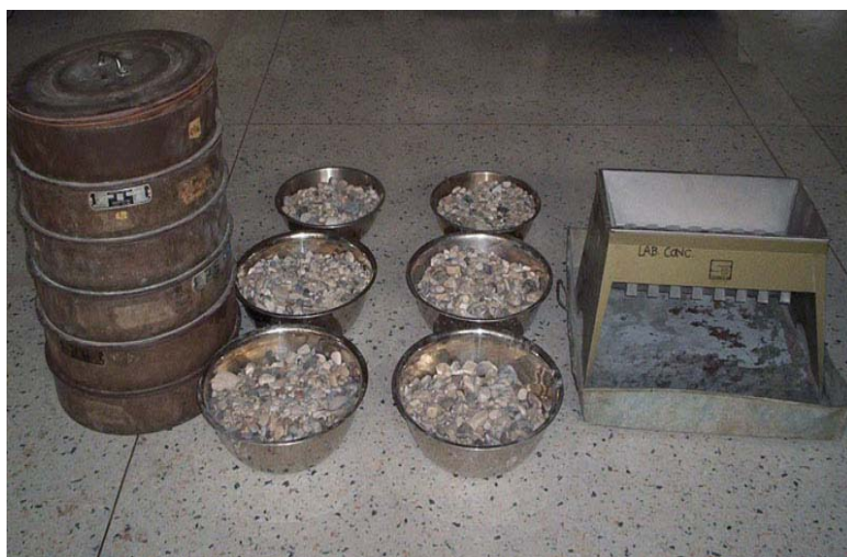
ภาพที่ 5 อุปกรณ์การวิเคราะห์หาขนาดละเอียดของมวลรวมหยาบกรวดแม่น้ำ
