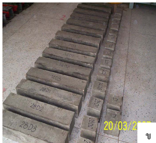
ภาพที่ 11 ก. การแต่งผิวคอนกรีตให้เรียบ ข. คอนกรีตที่แกะออกจากแบบหล่อแล้ว
