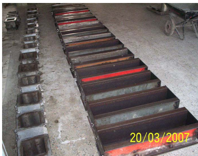
ภาพที่ 10 แบบหล่อสี่เหลี่ยมลูกบาศก์และแบบหล่อนานที่ใช้หล่อตัวอย่างคอนกรีต
