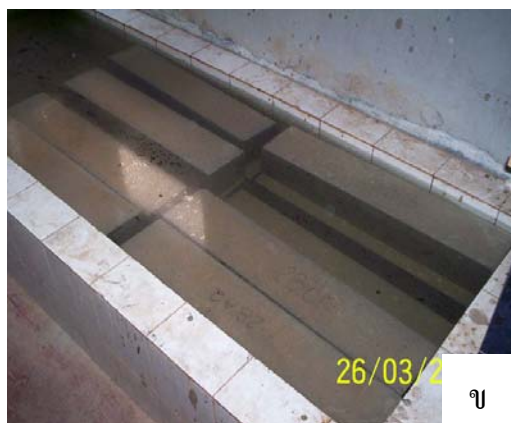
ภาพที่ 12 ก. แท่งตัวอย่างลูกบาศก์ที่บ่มในน้ำ และ ข. แท่งตัวอย่างคานที่นำไปบ่มน้ำ
