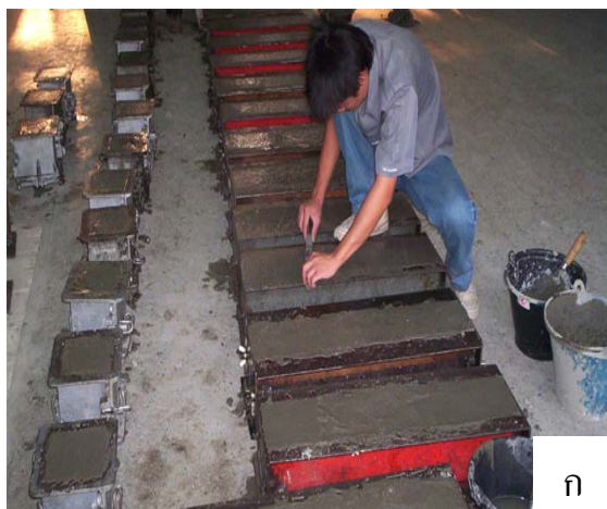
ภาพที่ 11 ก. การแต่งผิวคอนกรีตให้เรียบ ข. คอนกรีตที่แกะออกจากแบบหล่อแล้ว
