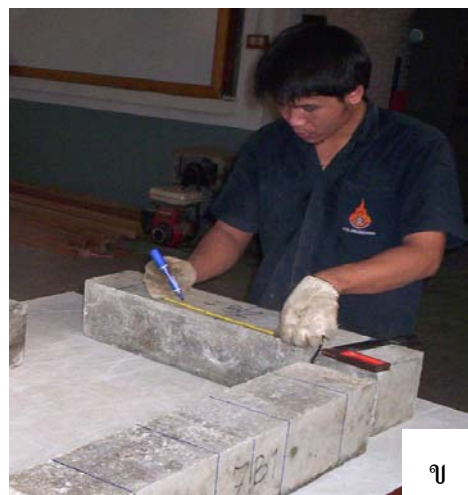
ภาพที่ 13 ก. ตัวอย่างคอนกรีตที่ได้อายุตามกำหนดนำขึ้นจากน้ำและ ข. วัดระยะเตรียมนำไปทดสอบ
