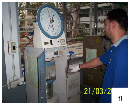
ภาพที่ 14 ก. การทดสอบหาค่าลึงอัดประลัยของคอนกรีตแท่งตัวอย่างสี่เหลี่ยมลูกบาศก์ ข. ตัวอย่างที่ทดสอบค่าลึงอัดประลัยเสร็จแล้ว
