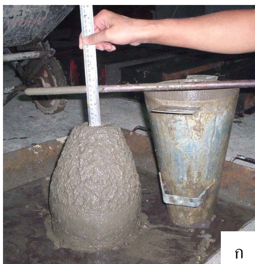
ภาพที่ 9 การตรวจสอบความสามารถในการเทได้ ก. คอนกรีตสดที่ใช้มวลรวมหยาบหินไม่ ข. คอนกรีตสดที่ใช้มวลรวมหยาบกรวด
