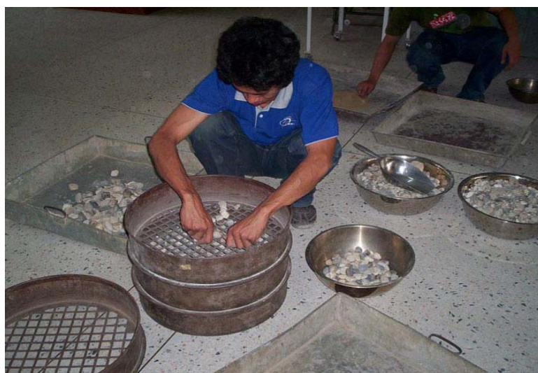
ภาพที่ 6 การวิเคราะห์หาขนาดละเอียดของมวลรวมหยาบกรวดแม่น้ำ
