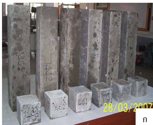
ภาพที่ 13 ก. ตัวอย่างคอนกรีตที่ได้อายุตามกำหนดนำขึ้นจากน้ำและ ข. วัดระยะเตรียมนำไปทดสอบ
