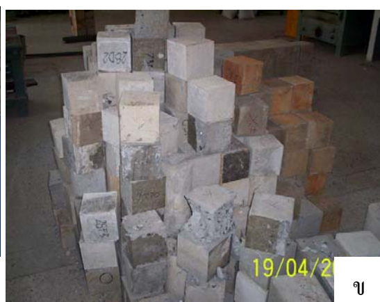
ภาพที่ 14 ก. การทดสอบหาค่าลึงอัดประลัยของคอนกรีตแท่งตัวอย่างสี่เหลี่ยมลูกบาศก์ ข. ตัวอย่างที่ทดสอบค่าลึงอัดประลัยเสร็จแล้ว
