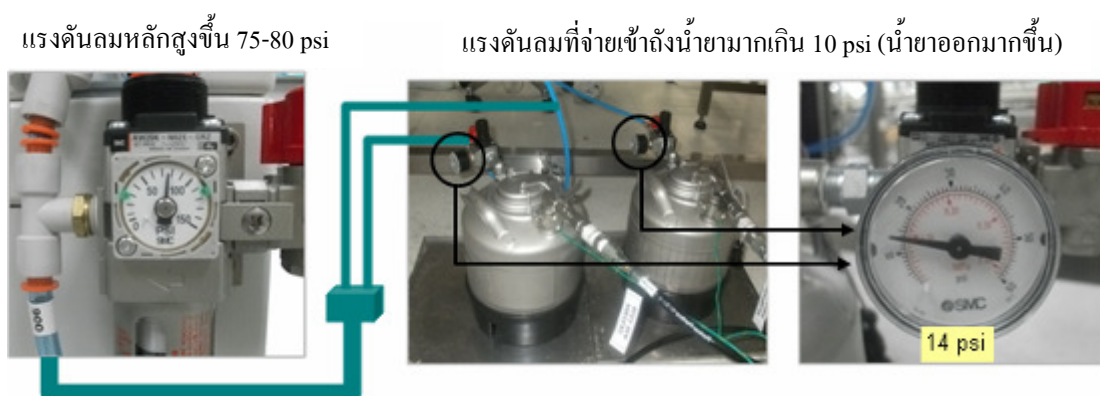
รูปที่ 4.12 แสดงแรงดันหลักสูงขึ้น ทำให้แรงดันที่จ่ายเข้าถึงน้ำยามากกว่า 10 psi (น้ำยามาก)
