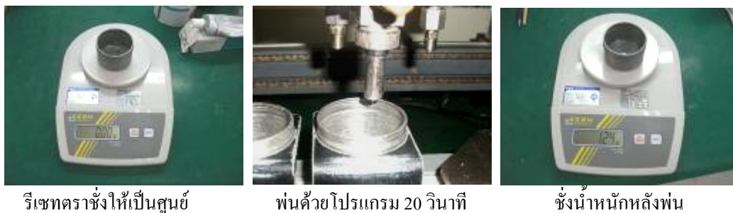
รูปที่ 4.17 แสดงขั้นตอนการวัดปริมาณน้ำยาเคลือบด้วยวิธีการชั่งน้ำหนัก
