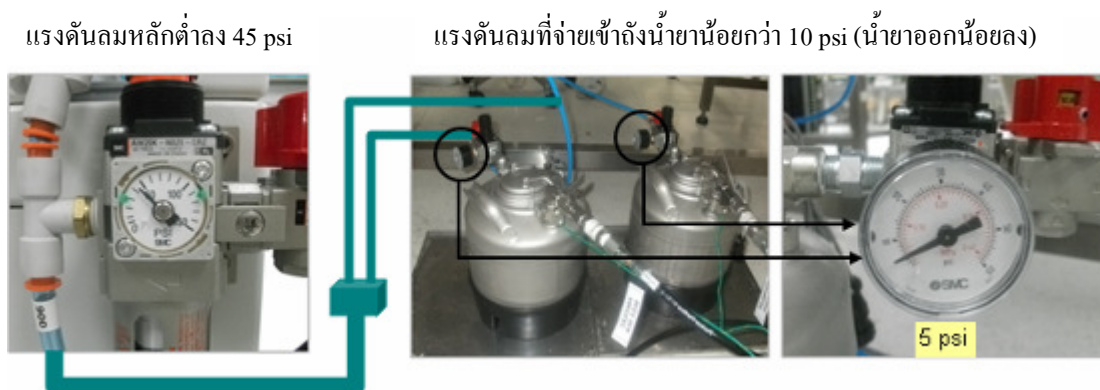
รูปที่ 4.11 แสดงแรงดันหลักต่ำลง ทำให้แรงดันที่จ่ายเข้าถึงน้ำยาน้อยกว่า 10 psi (น้ำยาน้อย)
