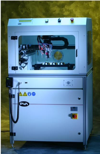
รูปที่ 3.6 แสดงลักษณะเครื่องเคลือบกึ่งอัตโนมัติ (Semi-Auto Coating Machine)
