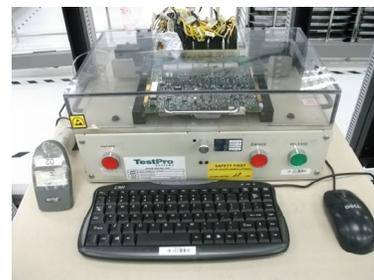
รูปที่ 3.11 แสดงการทดสอบการทำงานของผลิตภัณฑ์ (Functional Circuit Test)
