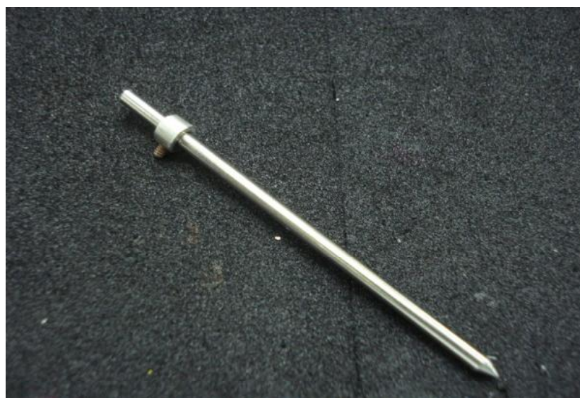
ภาพที่ 3.6 แสดงอุปกรณ์ปรับตั้ง (Alignment steel)
